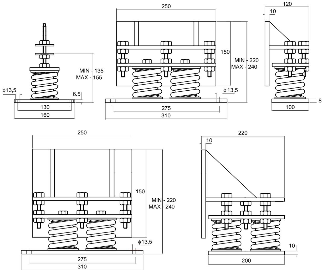
Os Niveladores **VIBRANIHIL** se apresentam como uma idéia que visa facilitar a instalação de máquinas equipadas com amortecedores, permitindo regulagem milimétrica. Indicado em novas instalações onde o peso do equipamento vazio e com carga apresentam grande diferença.
