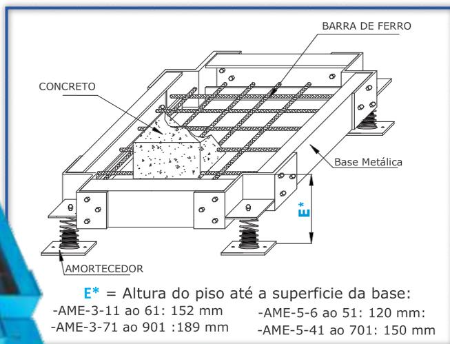
**Fornecida montada, basta adicionar o concreto (por conta do cliente).**
